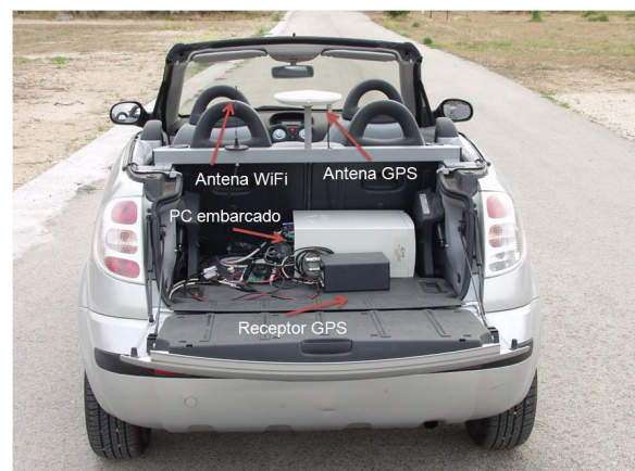
Figura 2. Sistema embarcado en Clavileño, un Citroën C3 Pluriel.
