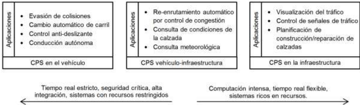
Figura 6: Espectro de oportunidades de investigación de CPS en el marco de los ITS. Figura basada en (Gokhale et al., 2008)
