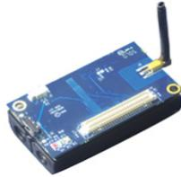
Fig. 2. ZigBee mote
